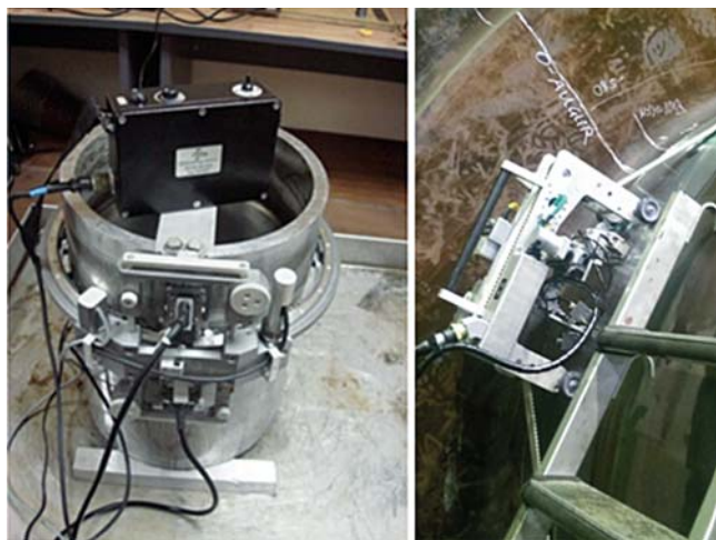
Рис. 6. Одно- и двухкоординатный сканеры для системы АВГУР-АРТ
