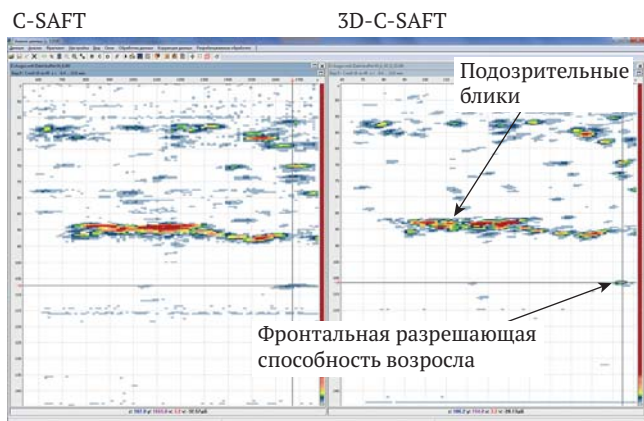
Рис. 10. Изображения D-типа СС, восстановленные методом C-SAFT (слева) и 3D-C-SAFT (справа)
