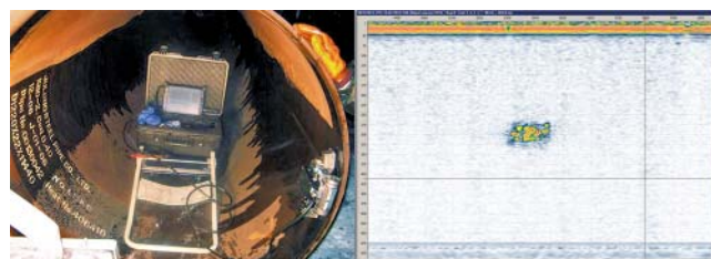
Рис. 6. Система АВГУР-Т внутри трубопровода (слева) и изображение недопустимого дефекта, протяженностью 150 мм, полученное методом Ф-ПСП (справа)
