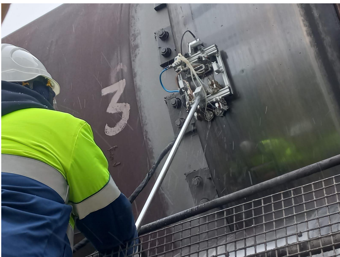
Фото 5. Сканер с рукояткой направления контроля, установленный на бандаже.
