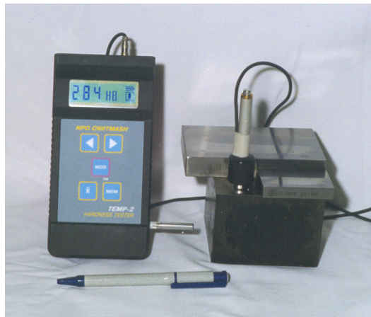
Рис.11 Общий вид портативного электронного твердомера ТЭМП.
