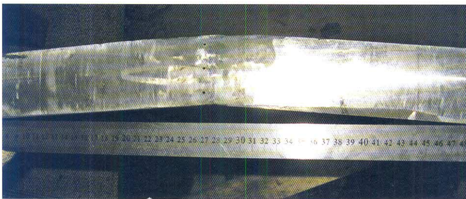
Рис. 5. Образец с пластинами, сваренными под углом 5°
