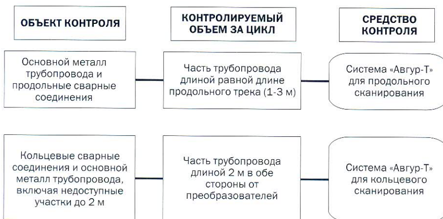
Рис. 2. Технология выполнения 100 % контроля трубопроводов системой «Авгур-Т»
