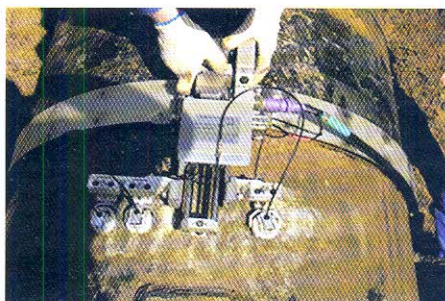
Рис. 6. Автоматизированный голографический контроль сварных соединений тройников с накладками магистральных газопроводов
