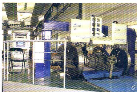
Рис. 5. Система диагностики колесных пар железнодорожных вагонов: а – мобильная система контроля КП со свободной средней частью; б – стационарная, встраиваемая в поток система для контроля КП со свободной средней частью или с редуктором привода генератора, или с тормозными дисками
