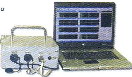
Рис. 1. Различные варианты системных блоков: а – системный блок на базе промышленного компьютера, б – в конструктиве переносного ящика с планшетным компьютером или ноутбуком, в – системный блок для использования в сложных климатических условиях с подключенным к нему ноутбуком
