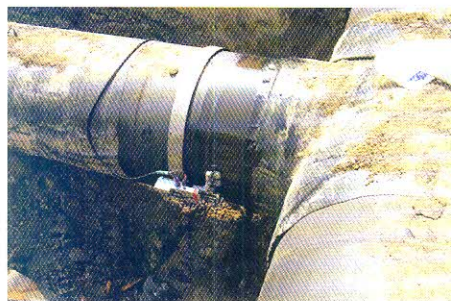
Рис. 6. Автоматизированный голографический контроль сварных соединений тройников с накладками магистральных газопроводов
