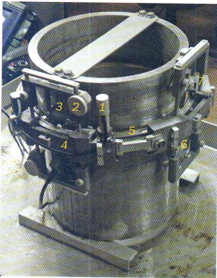
Рис. 8. Сканер Т300 системы «Авгур 6» на образце трубы Ду300: 1 – мотор-редуктор, 2 – маховик каретки x, 3 – прижимы для АР, 4 – основная часть сканера, 5 – трек, 6 – дополнительная часть сканера, 7 – прижимы для АР
