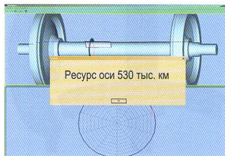
Рис. 2. Колесная пара с дефектом в оси; указан ресурс оси, рассчитанный с учетом данных УЗК
