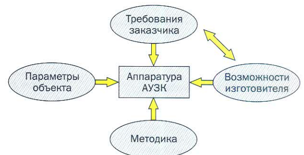
Рис. 2. Факторы, влияющие на архитектуру аппаратуры
