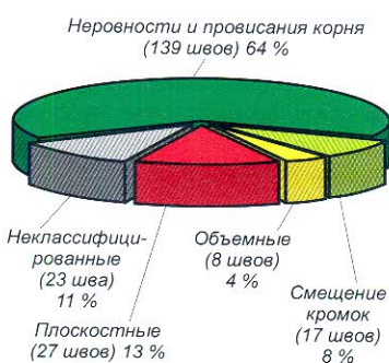
Рис. 10. Классификация несплошностей по результатам экспертного контроля на Волгодонской АЭС в 2000 г.
