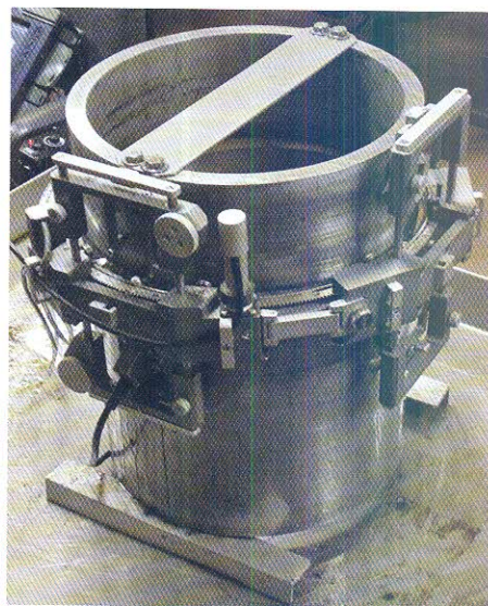
Рис. 9. Сканер T-300 для дефектоскопов с ФАР
